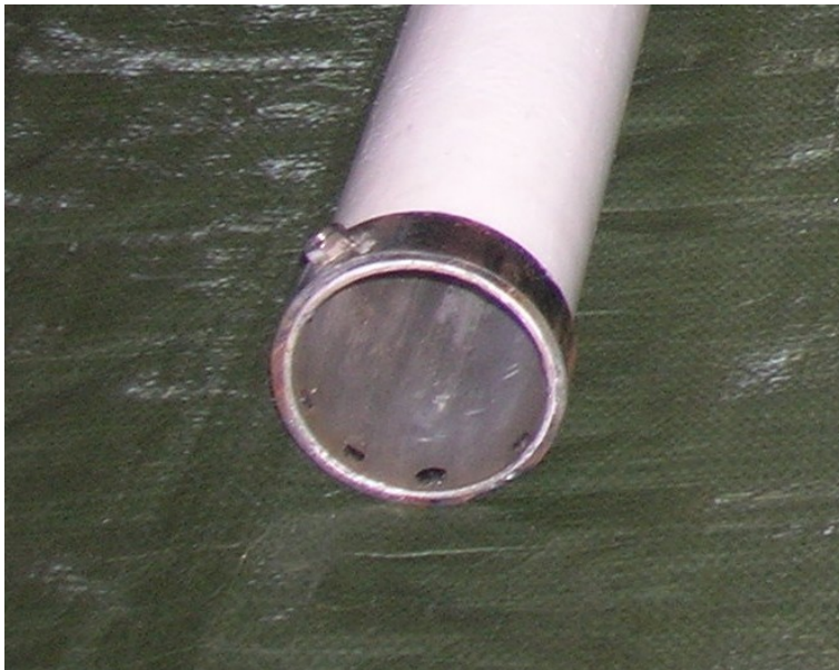
Aan de bovenzijde wordt het mastdeel wat er in schuift, op zijn plaats gehouden door 4 – 8 kleine plastic dopjes die slechts 1 mm uitsteken.
