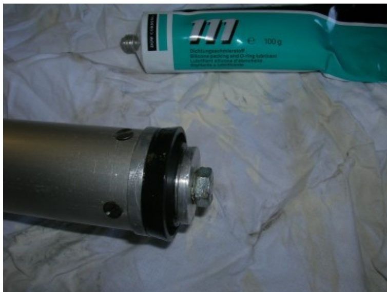
Een gemonteerde seal, ruim ingevet met Molikote siliconenvet (met dank aan Frank, PE1EWR)
