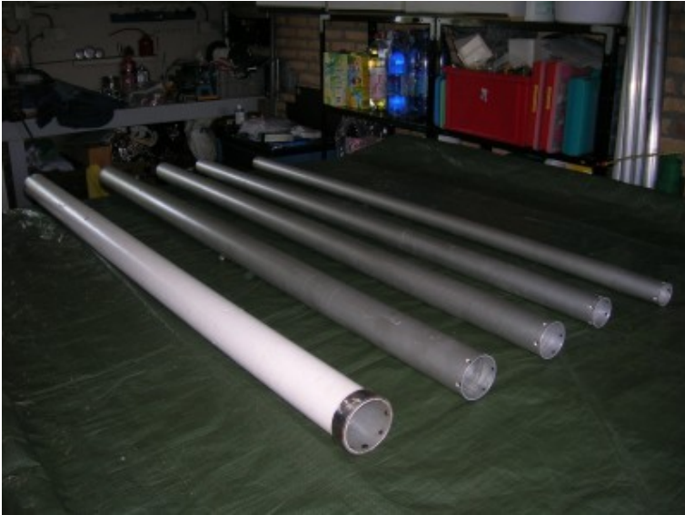
De 5 mastdelen, schoongemaakt en klaar voor montage
